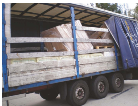
Figur 19: Otillräcklig lastsäkring med enbart lindad sträckfilm.
