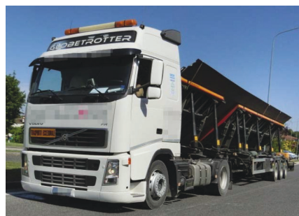
Figur 14: Stålplasser som transporteras i 45°
