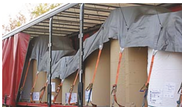
Figur 31: Lastsäkring med överdrag
