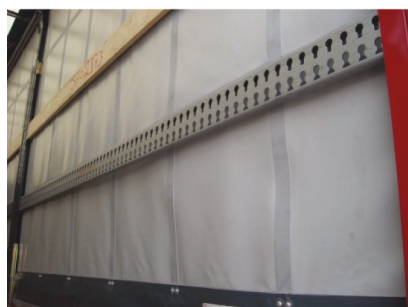
Figur 27: Aluminiumskena med hål för blockeringsstänger
