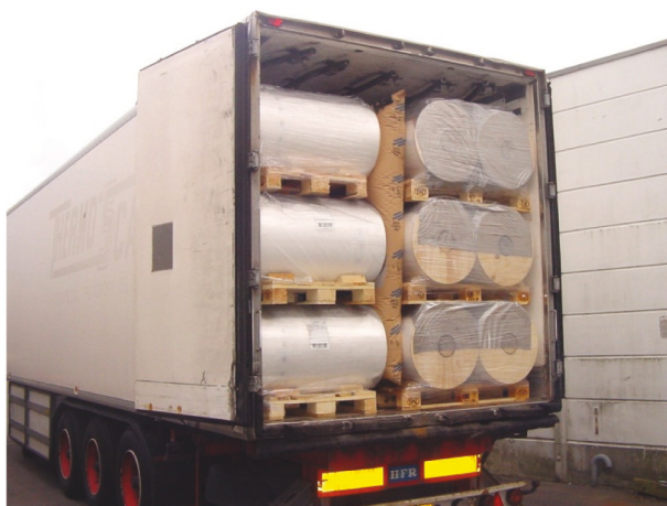
Figur 28: Fyllnadsmaterial mellan rader av last.
