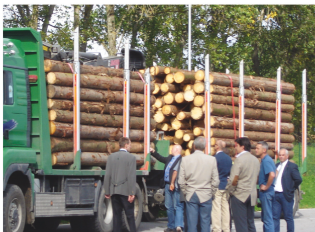
Figur 51: Säkring av rundvirke
