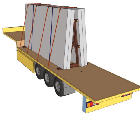
Figur 48: Lastsäkring med en kombination av blockering, A-bock, buntsurring och överfallssurring.
