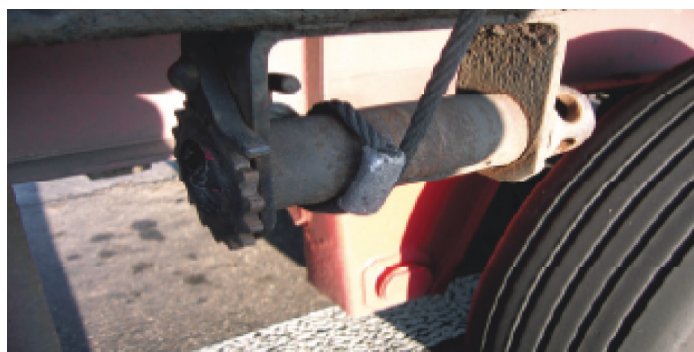
Figur 24: Stålvajer som spänns av vinsch
