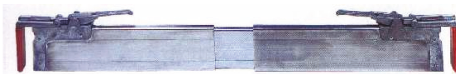
Figur 26: Blockeringsstång med friktionsbaserad fastsättning på sidoväggar/ribbor
