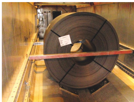
Figur 61: Transport av rulle i specialfordon
