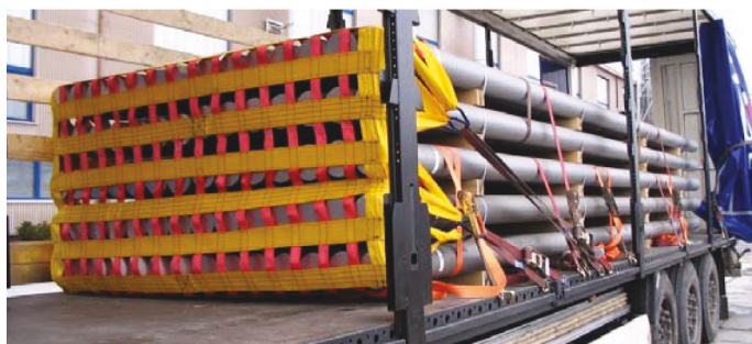
Figur 32: Lastsäkring med nät och direkt surrning i framlänges riktning
