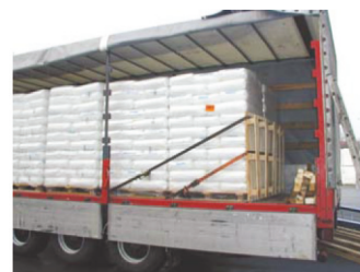
Figur 39: Surrning med grimma med användning av pallar
